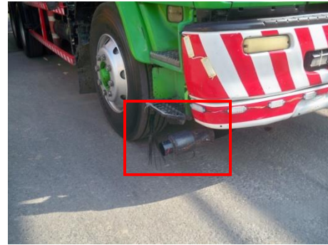
ภาพที่ 2.2-14 ที่ครอบท่อไอเสียป้องกัน การเกิดประกายไฟ
